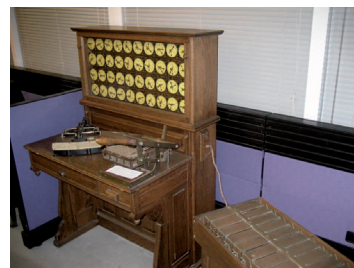
Děroštitkový počítač pro automatizované zpracování sčítání 1890. Foto: Adam Schuster – Flickr: Proto IBM
